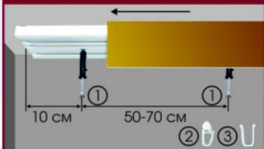
1. Разметить и просверлить отверстия в пластиковом профиле и потолке. Шаг отверстий от торца профиля - 10 см, далее - 50-70 см в зависимости от размера карниза.
